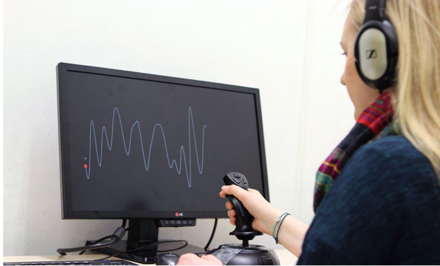
Abb. 1 Illustration des Versuchsaufbaus. Teilnehmende verfolgten die Spur eines Zielobjektes mittels Joystick und reagierten auf Tonsignale mittels Pedaldruck.
