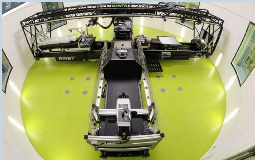
Kurzarm-Humanzentrifuge in der Forschungsanlage Envihab des DLR.
