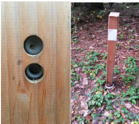
Abbildung 4: Schäden an Sensoren: eingedrückte Linse (links), Sticker über dem Sensor (rechts) (Nationalparkverwaltung Eifel)
