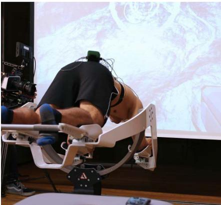
Icaros ist ein Trainingsgerät, mit dessen Hilfe die klassische Übung des Unterarmstützes (Plank) dynamischer gestaltet werden kann, da es beweglich ist. Bewegungssensoren auf dem freischwingenden Metallgestell erfassen die Richtungsänderungen des Benutzers, der in Bauchlage waagrecht in dem Gerät liegt – und übersetzen sie in eine virtuelle Realität (VR). Eine VR-Brille und ein großer Bildschirm
