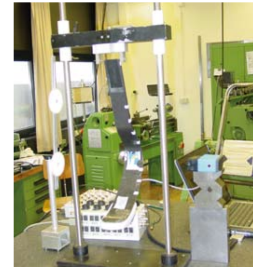
Messaufbau zur Bestimmung der Trägheitseigenschaften der Prothese. Aus der Schwingungsdauer der pendelnd aufgehängten Prothese wird das Trägheitsmoment bestimmt.
