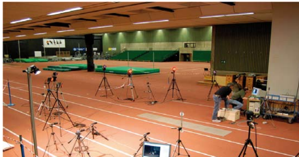
Abb. 1 Laufstrecke im LAZ mit Kraftmessplatten und Highspeed Infrarotkameras (links). Marker auf ausgewählten anatomischen Punkten der unteren Extremität und Prothese (mitte und rechts).
