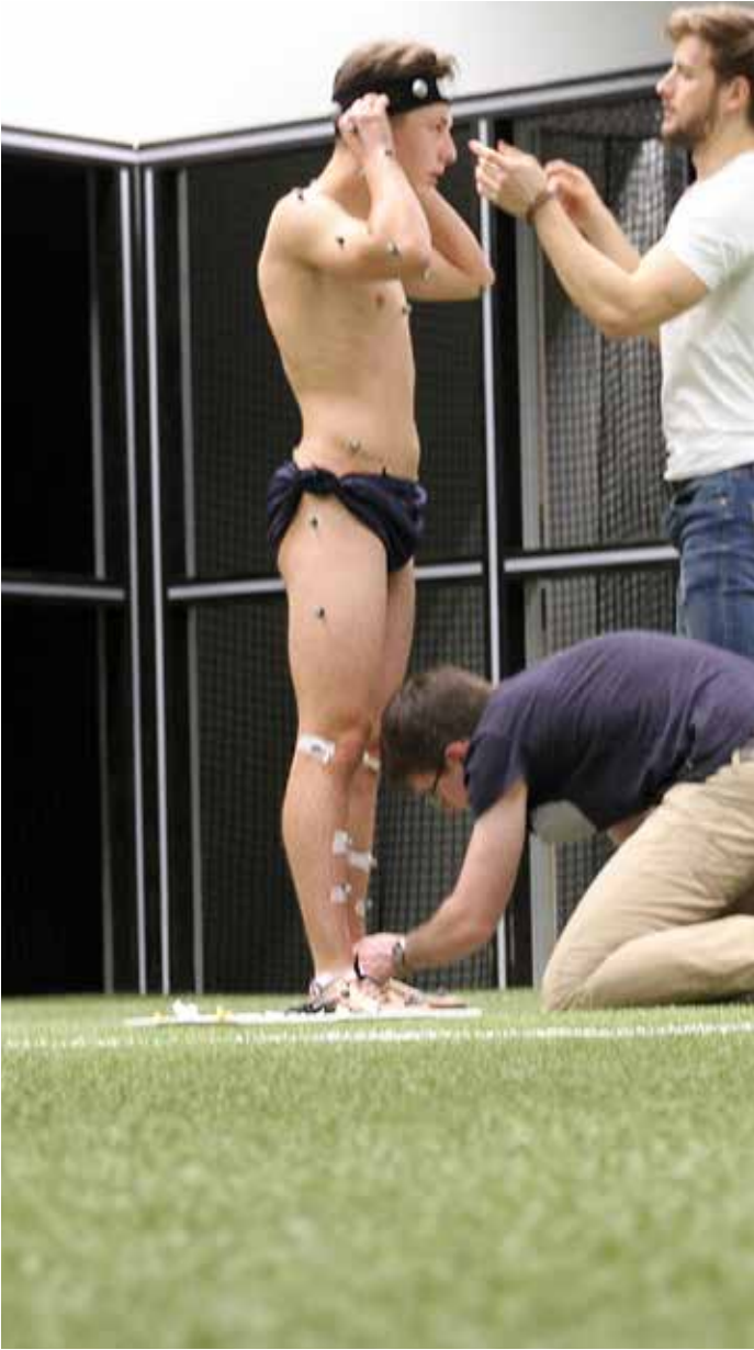
65 reflektierende Marker werden am Körper der Nachwuchsfußballer befestigt und von 16 Infrarot-Highspeed-Kameras erfasst. Die Bewegungsabläufe können so dreidimensional erfasst und dargestellt werden.
