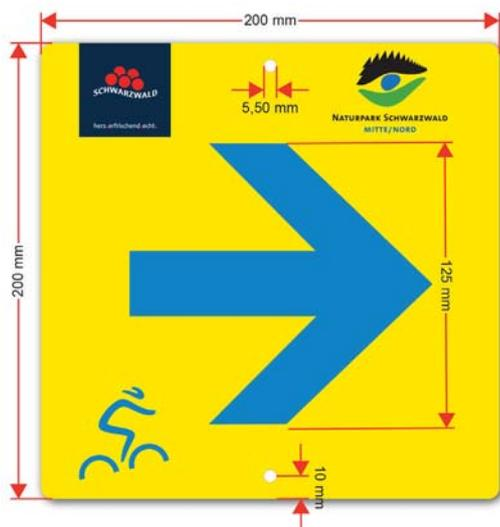
Abbildung 18: Bemaßung Zwischenwegweiser
