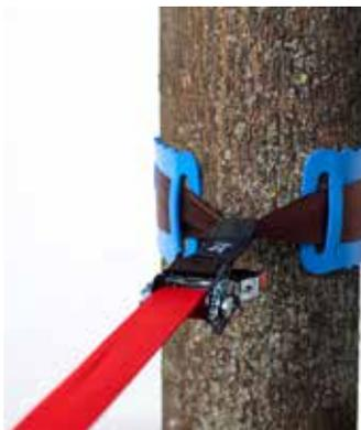
Abb. 10: Ankerstichsystem: durch die Einleitung der Kraft über die direkt um den Baum gelegte Slackline werden einseitig verstärkt Scherkräfte produziert insbesondere bei falscher, unzentrierter Anbringung
