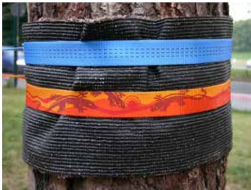
Abb. 9: Hochwertiges Anschlagssystem der Firma „alpinstil“: durch Separierung von Slackline und Baumschlinge Minimierung der Scherkräfte; 10 cm breite Auflagefläche der Baumschlinge verringern den Druck, Zweikomponenten Abriebschutz der die Bewegung der Baumschlinge durch die Slackline auf seiner glatten Seite aufnimmt
