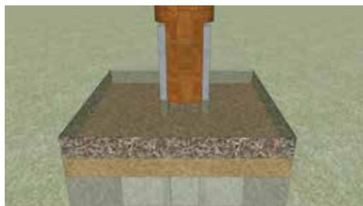
Abb. 15: Detaildarstellung einer weiteren konstruktiven Lösung vergleichbar mit Abb. 13 jedoch mit nach außen gerichteten U-Profilen, geringfügig erhöhte Verletzungsgefahr durch möglichen Kontakt an den Stahlbauteilen; Seitenansicht (l.), Aufsicht (r.)
