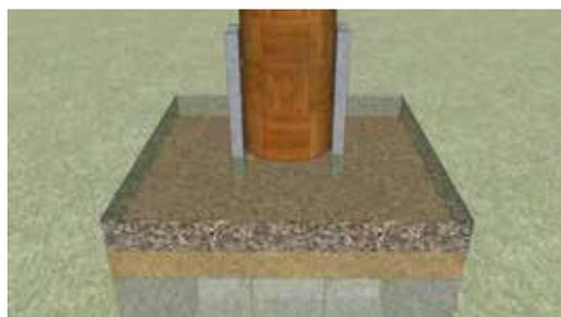
Abb. 16: Holzpfosten eingespannt in mehreren auf dem Konstruktionsholz aufliegenden, nach außen gerichteten U-Profilen, erhöhte Verletzungsgefahr an den Stahlbauteilen; Seitenansicht (l.), Aufsicht (r.)
