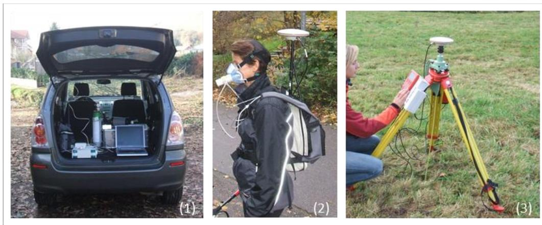
Abb. 3-3: Technische Ausstattung zur Vorbereitung und Sicherung der Messungen (1), Probandin mit portablen Spirometrie-System und Rover (2) sowie Referenzstation des dGPS-Gerätes (3)
